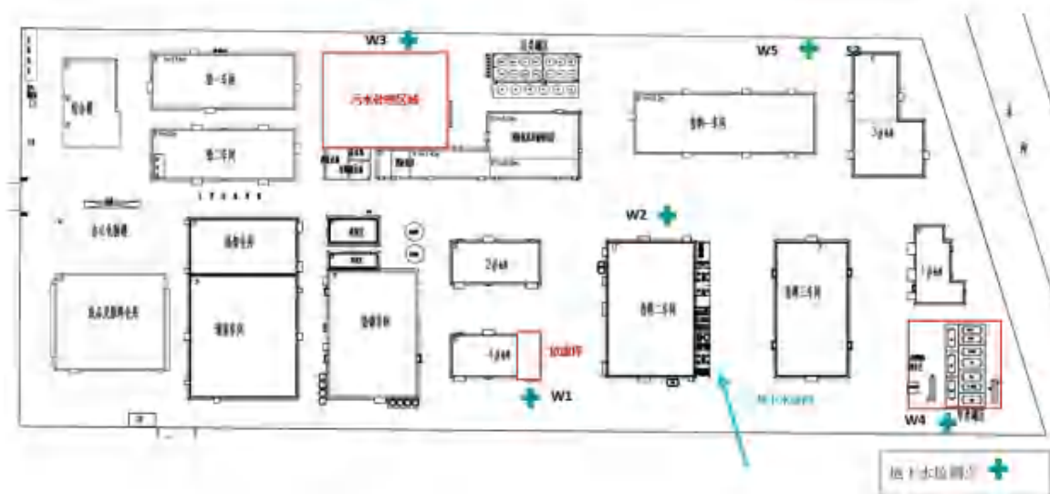
图 4-6 厂区内地下水监控井
