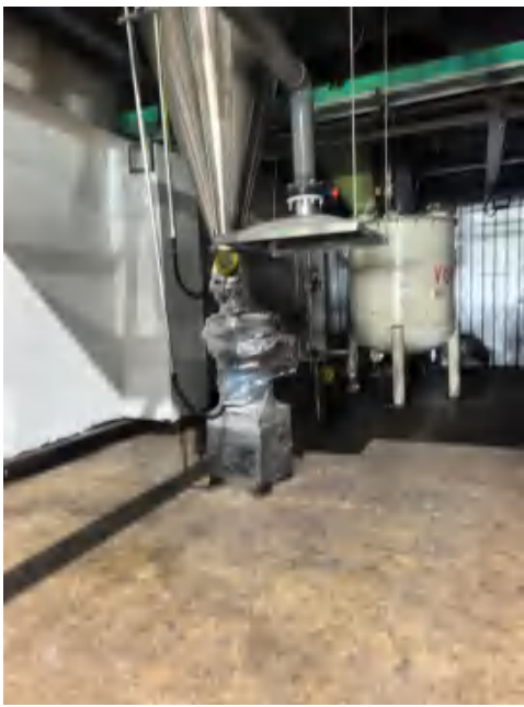
碳酸锰/二氧化锰 筛分机上方集气罩
